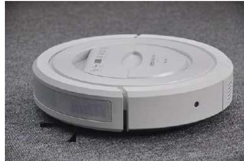
图 16 运用激光雷达的扫地机器人
