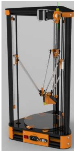
图 4 Delta 三角洲打印机示意图
